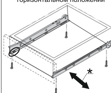
Регулировка направляющей в
